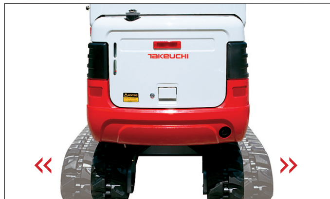
Raupenfahrwerk mit hydraulischer Spurverbreiterung
